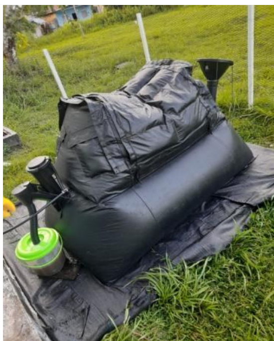
Figura 2. Biodigestor modelo doméstico utilizado na realização do trabalho.
